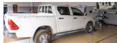
Gari la serikali ikifanyiwa ukaguzi katika karakana ya TEMESA Mkoani Mbeya kwa kutumia mashine ya kisasa (3D alignment mashine) kupima " wheel alignment"
