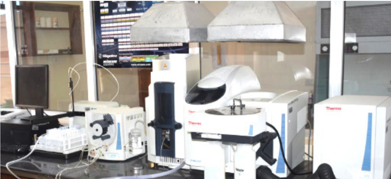
Atomic Absorption Spectrophotometer (AAS). Mtambo ambao hutumika kubaini kiasi cha dhahabu na madini mengine kwenye sampuli mbalimbali ikiwemo udongo na maji.
