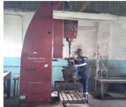
Mtaalamu kutoka kitengo cha uchongaji akichonga "block" ya injini kwa ajili ya kuvisha "sleeve"
