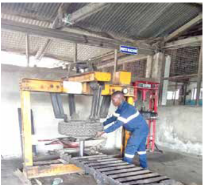
Mtaalamu kutoka kitengo cha matengenezo ya magari akitoa lingi kwenye talli kwa kutumia mashine maalumu (hydraulic tyre remover)
